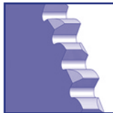
BW Zahnform B mit wechselseitigem Anschliff
