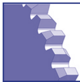
AW Zahnform A mit wechselseitigem Anschliff
