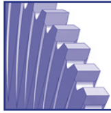
2- / 3-seitig schneidend nur mit Freiwinkel über 1 Zahn
